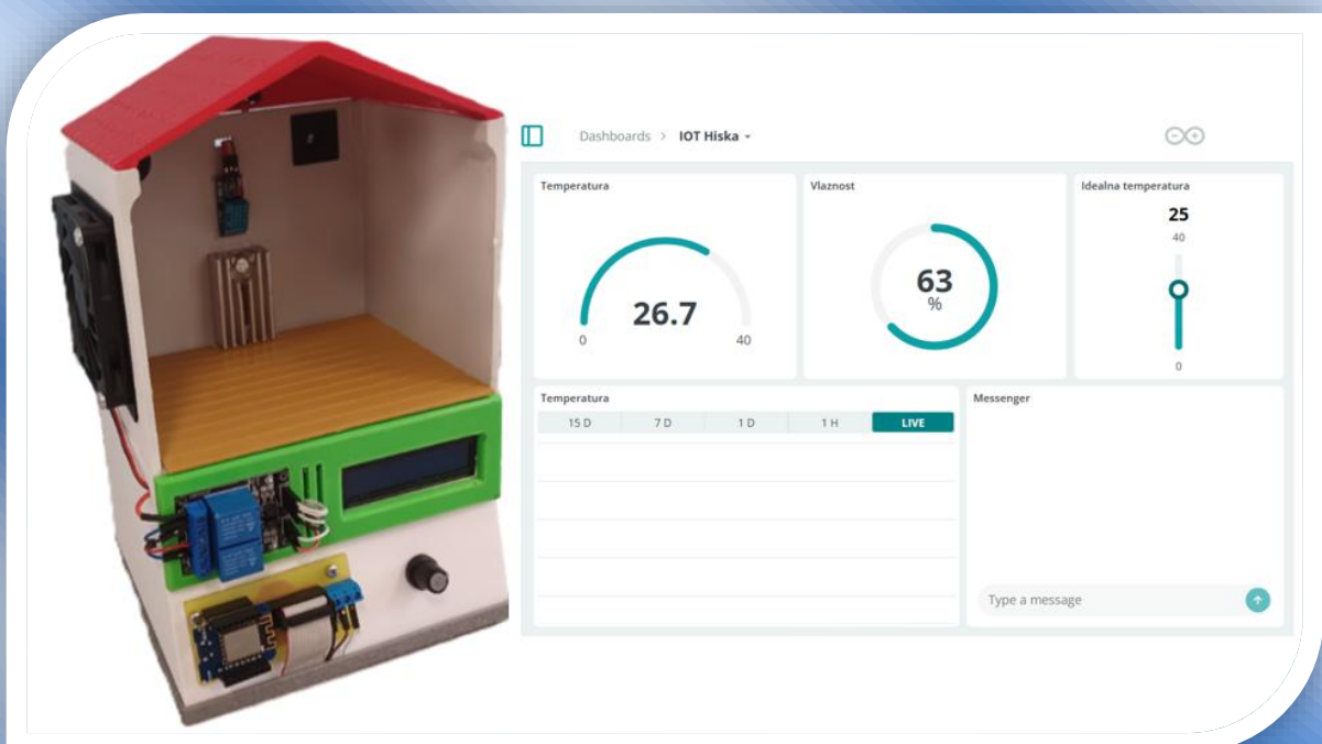
Tian Subotić – IOT hiška, daljinsko vodenje temperature, luči in alarma
